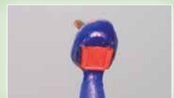
Przykleić kanał odlewniczy. Praca gotowa do odlania.
