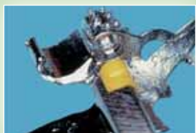
Odelek wykończony. Włożyć matrycę przy pomocy klucza.
