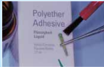
Pokryć trzpień materiałem klejącym.
